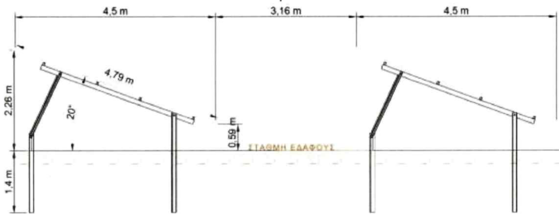
Σχέδιο3. Πλάγια όψη βάσης στήριξης με Φ/Β πλαίσια
